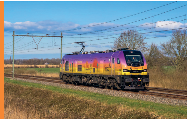
Die EURO 9000 Lok fährt hybrid, mit Diesel und elektrisch
